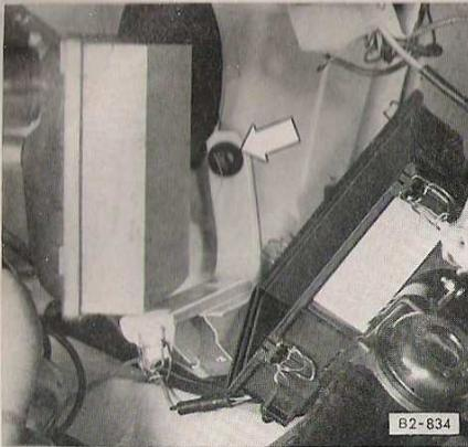
Remettez l'élément papier avec précaution en faisant attention que le joint soit correctement placé.
